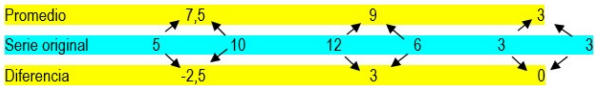
Figura 2. Ejemplo de descomposición Wavelet con promedio (pasa bajo) y diferencia (pasa alto)
